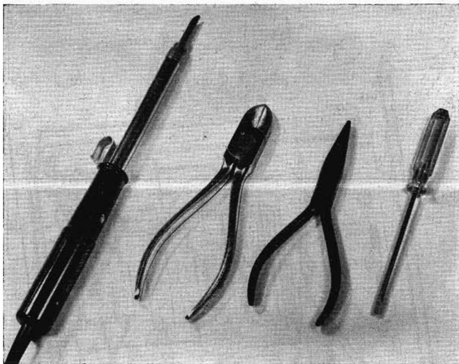
Met dit gereedschap is het goed werken! Van links naar rechts: Solon soldeerinstrument, zijknijptang, platbektang en schroevendraaier.
