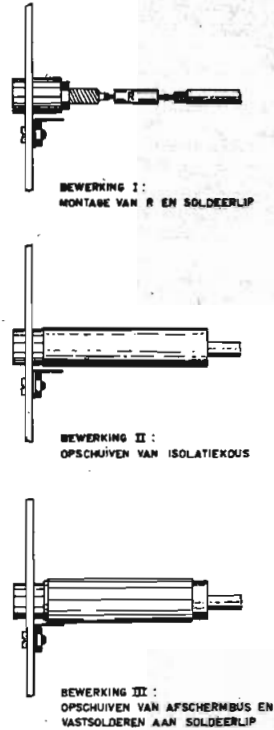
Fig. 11. De montage aan de geïsoleerde stekerbuis.
